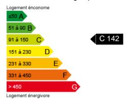
Consommations énergétiques (en énergie primaire) pour le chauffage, la production d'eau chaude sanitaire et le refroidissement.
